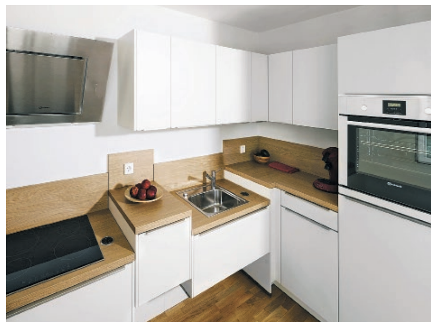
Kochfeld und Spültisch in der ergonomisch gestalteten Küche sind als höhenverstellbare Hubmodule eingebaut.
